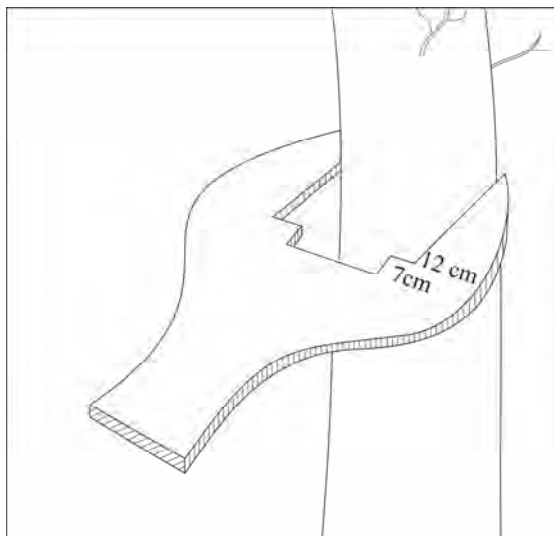
Obr. 5-5 Speciální miniprůměrka pro zjištění prahových tlouštěk stromů
